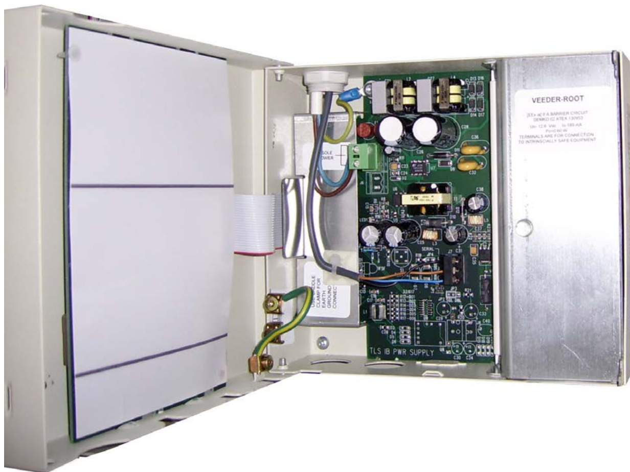
Rysunek 12: Moduły bariery iskrobezpiecznej TLS-IB.
