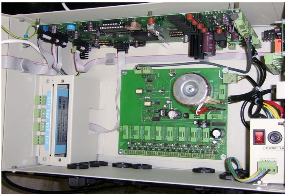
Rysunek 5: Widok wnętrza centralki Tank Ranger model 4 dla sond DigiMag.
